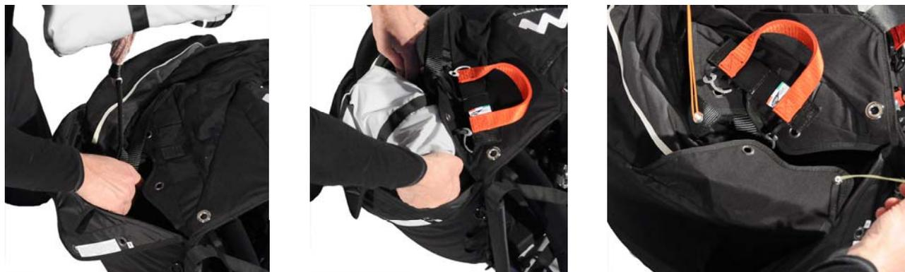
Führen Sie eine dünne Leine (Gleitschirmleine) in die Gummischlaufen, dann fädeln Sie die Ösen des Gurtzeug-Containers auf, beginnend mit den kleinsten, um diese unter Zug zusammenzuziehen. Folgen Sie dabei der Reihenfolge, die im Bild/Zeichnung ersichtlich ist.
