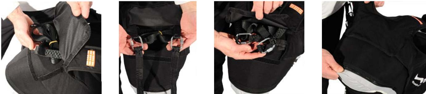
Für diese Verbindung benötigt man zwei Schraubkarabiner mit einer Bruchlast von mindestens 1400 kg. Es muss sichergestellt werden, dass die Länge der Verbindungsleine ausreicht, um das Rettungsgerät in den dafür vorgesehenen Rettungsgeräte-Container des Gurtzeugs einzufügen. Es muss genügend Leinenlänge vorhanden sein, um sicherzustellen, dass bei der Betätigung des Rettungsfallschirms der Rettungsschirm noch im Rettungsschirm-Container bleibt, bis er geworfen wird.
