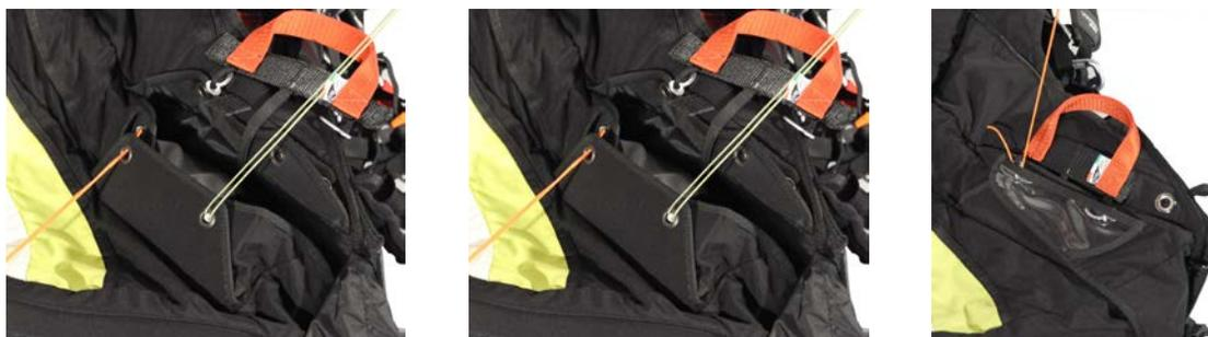
Führen Sie die metallischen Splinte in die elastischen Schlaufen unter der transparenten Abdeckung. Die Leine, die zur Hilfe genommen wurde, muss nun unbedingt entfernt werden. Ziehen Sie die Leine langsam heraus, um die elastischen Schlaufen nicht durch zu hohe Reibung zu beschädigen. Am Ende wird der Griff unter der elastischen Abdeckung eingesetzt.
