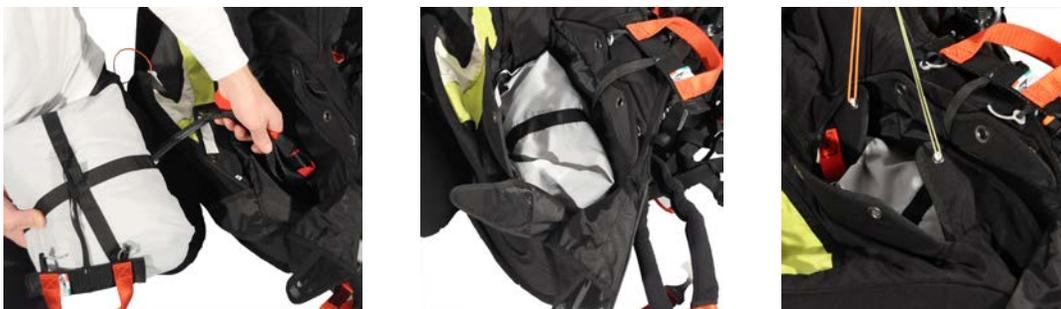
Führen Sie eine dünne Leine (Gleitschirmleine) in die Gummischlaufen, dann fädeln Sie die Ösen des Gurtzeug-Containers auf, beginnend mit den kleinsten, um diese unter Zug zusammenzuziehen. Folgen Sie dabei der Reihenfolge, die im Bild/Zeichnung ersichtlich ist.
