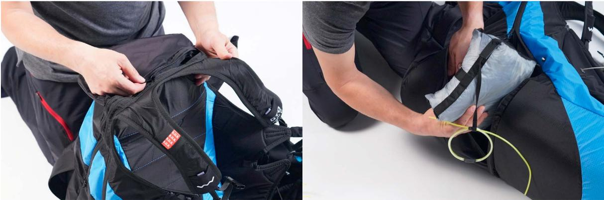
Inserte el paracaídas y su mazo de cintas en el contenedor del arnés manteniendo el triángulo (de conexión entre asa y bolsa de lanzamiento) orientado hacia arriba y el mazo de cintas hacia la cola del arnés. Complete la operación introduciendo el asa en su alojamiento.
