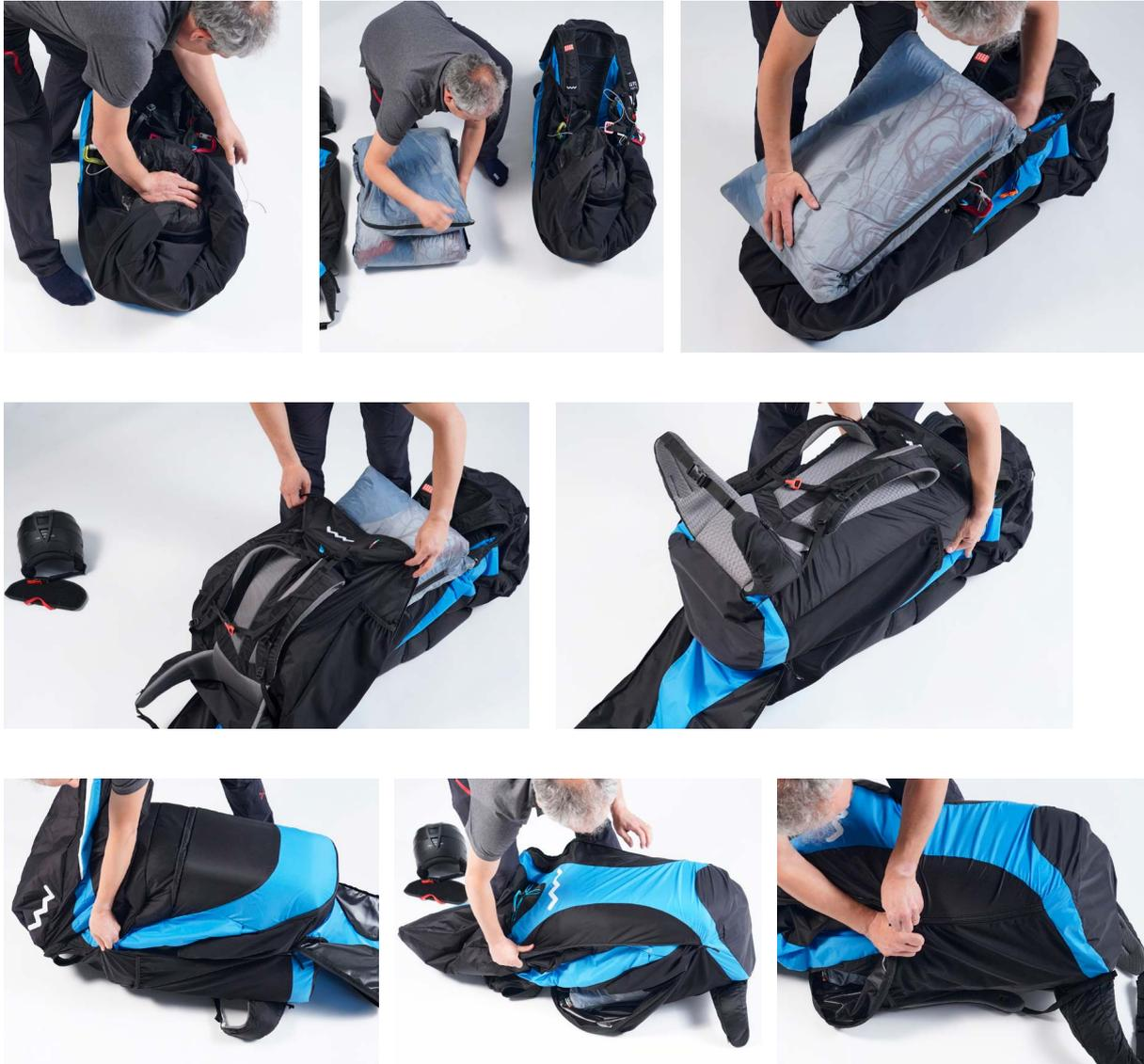
Una vez que se inserta el arnés, dé la vuelta a todo el fardo y cierre la cremallera. Doble la cola por dentro, los materiales utilizados permiten cualquier grado de intensidad de plegado sin que afecte a su funcionamiento durante el vuelo. Se dispondrá de suficiente espacio en la parte superior para los instrumentos y el casco.
