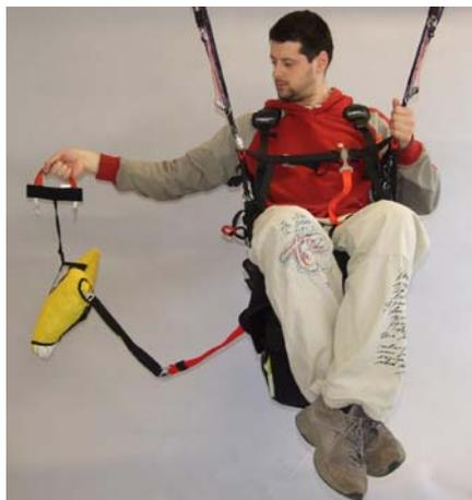
**ATTENZIONE:** per evitare anomali caricamenti laterali, la fune va agganciata a tutte due le asole poste sulle rispettive spalline. Non solo ad una delle due.
