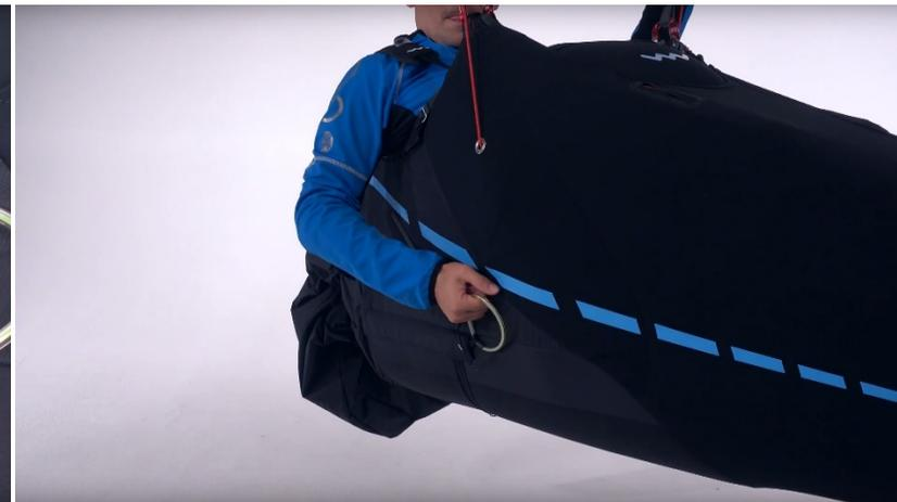
Danach sind alle Packschnüre zu entfernen. Die Schnüre bitte langsam abziehen, da sonst die Gummis durchgesägt werden.
