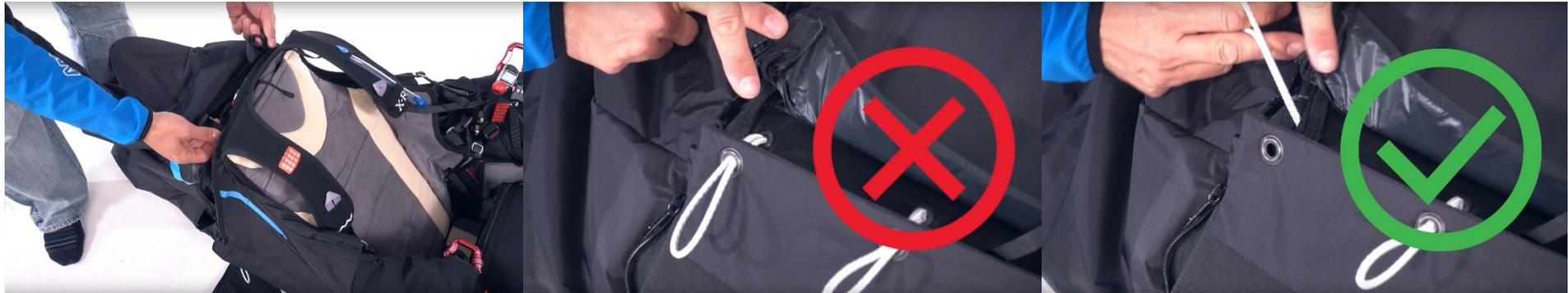
Eine Hilfsleine wird jetzt durch die elastischen Verschlußgummis gefädelt.
