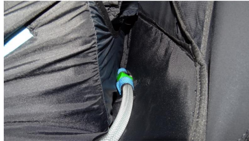
Der Sitz des Ballastes befindet sich unter dem Sitzbrett: Um darauf zuzugreifen, den Reißverschluss öffnen. Dann den Ablassschlauch durch die Öffnung auf der rechten Seite führen und den Ballast einsetzen. Den Schlauch in den Zwischenraum auf der rechten Seite einführen, bis er herauskommt. Das Ventil in die Öffnung einsetzen und den Schlauch mit dem blau Klettband befestigen, damit er sich nicht bewegt.
