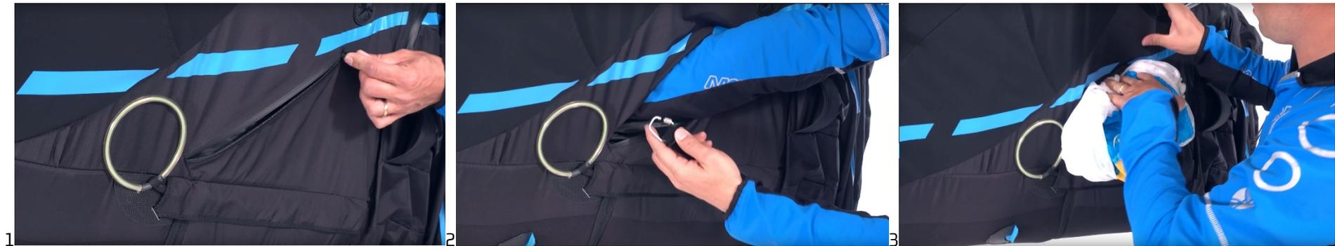
(1) Seitentasche "Anti-G"; (2) Karabiner zum Einhängen der Verbindungsleine des Bremsfallschirms; (3-4) Anti-G stau;
