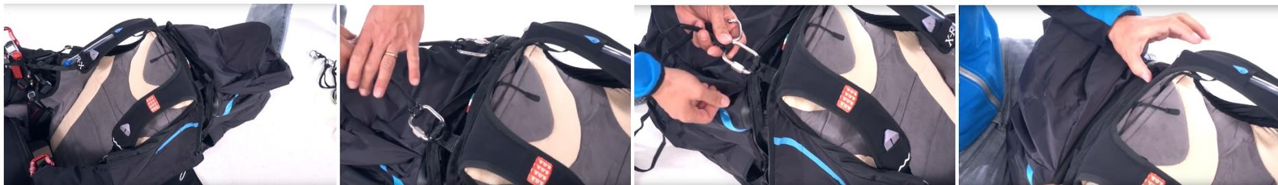
Für diese Verbindung benötigt man zwei Schraubkarabiner mit einer Bruchlast von mindestens 1400 kg. Es muss sichergestellt werden, dass die Länge der Verbindungsleine ausreicht, um das Rettungsgerät in den dafür vorgesehenen Rettungsgeräte-Container des Gurtzeugs einzufügen. Es muss genügend Leinenlänge vorhanden sein, um sicherzustellen, dass bei der Betätigung des Rettungsfallschirms der Rettungsschirm noch im Rettungsschirm-Container bleibt, bis er geworfen wird.
