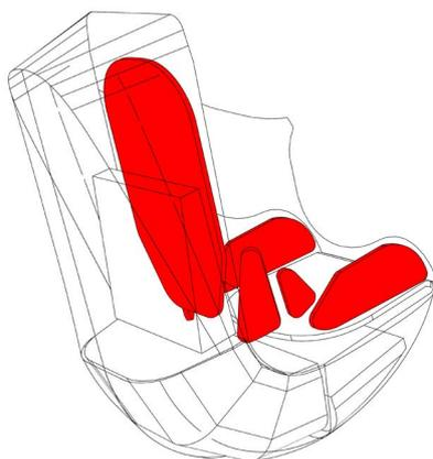
Einige dieser Elemente sind im unteren Rückenbereich der Basis befestigt und lassen sich nicht entfernen. Im Gegensatz dazu lassen sich die in den Seiten und der Rückenlehne des Gurtzeugs integrierten Seiten- und Rückenschilde bei Bedarf herausnehmen.
