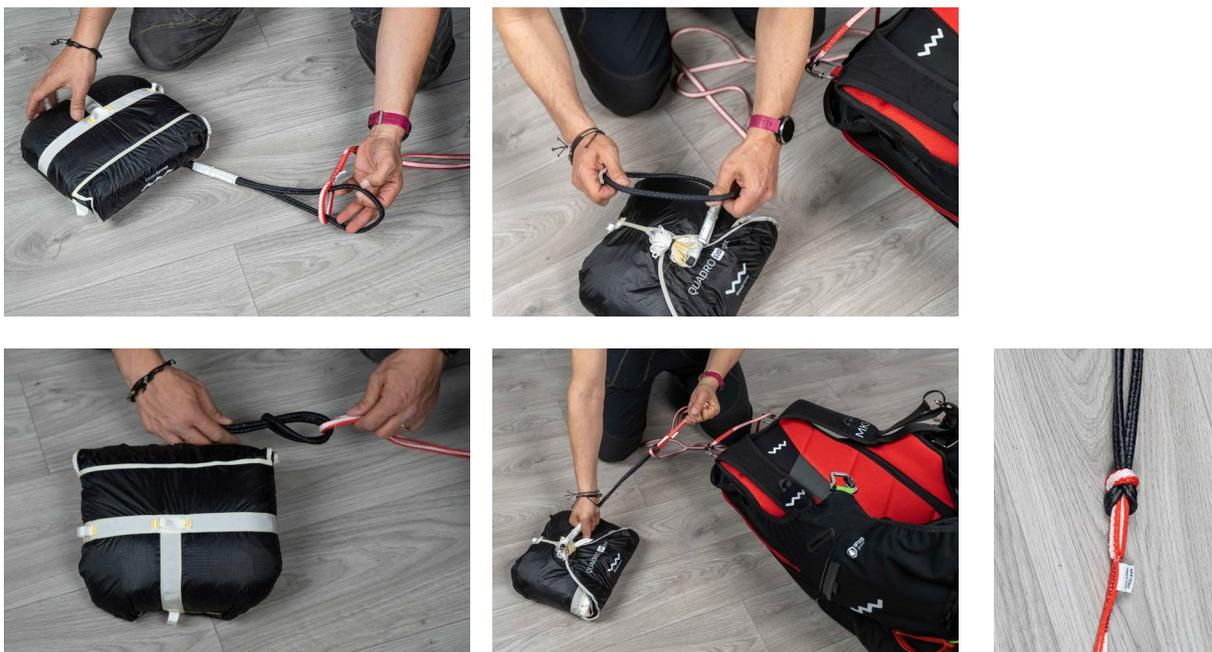
Tercer sistema: (adecuado para paracaídas pilotables o no pilotables, con una cuerda de brida doble)
