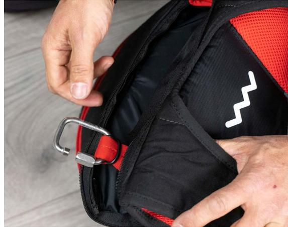
Las dos conexiones deben hacerse con mosquetones de tornillo con carga de rotura de por lo menos 1400 Kg. En cualquier caso, se debe verificar que la longitud de la cuerda de brida es suficiente para poder colocar el paracaídas de emergencia dentro del contenedor integrado en la silla y que haya suficiente holgura para poder extraer el paracaídas de emergencia sin que se despliegue la bolsa de lanzamiento durante la extracción.
