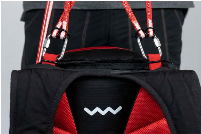
Bloquee la cuerda de brida y los loops con el OR, tal como se muestra en la fotografía.
