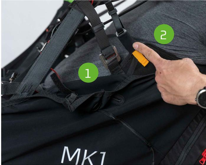
En detalle, el ajuste n°1 varía el ángulo entre las piernas y la espalda (profundidad del asiento), se distribuyen las cargas entre el asiento y la cinta lumbar, proporcionando así una mayor comodidad al piloto. El ajuste principal que permite elegir la inclinación del torso con respecto al eje vertical de vuelo es el ajuste n°2, un ajuste dorsal.
